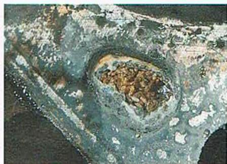
**GESTOPFT** Ablagerungen statt Wasser. Mit derartig verstopften Kanälen wird der Zylinderkopf nicht mehr ausreichend gekühlt
