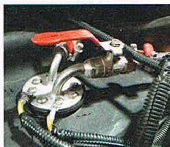
**Kraftstoffabsperrhahn** Sollte, wie hier, möglichst nahe am Tank installiert sein. Vor dem Starten prüfen, ob er auf „Offen“ steht
