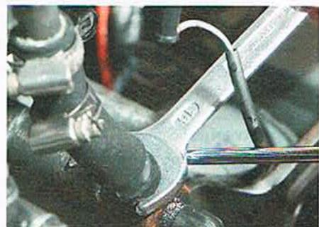
**GESCHOBEN** Festsitzende Schläuche lassen sich mit einem Gabelschlüssel und einem Hebel vom Nippel schieben
