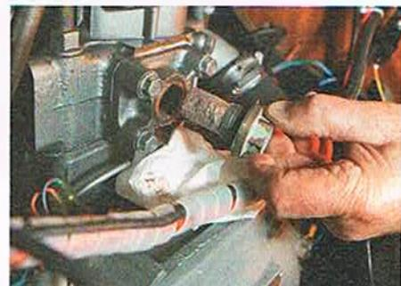
**GETROCKNET** Kühlwasser ablassen und wenn vorhanden die Zinkanoden entfernen, damit der Kreislauf austrocknet
