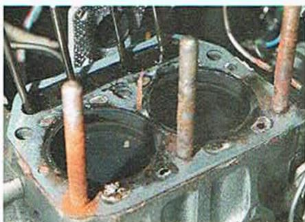
**GEROSTET** Der Kopf ist ab, die Dichtung hin. Die Stehbolzen sollten eigentlich nicht mit Wasser in Verbindung kommen
