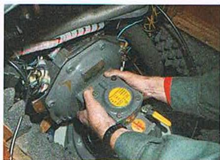
**GETRENNT** Zum Ausbau des Motors muss der Saildrive ab, dazu trennt man den Flansch zwischen Getriebe und Motor
