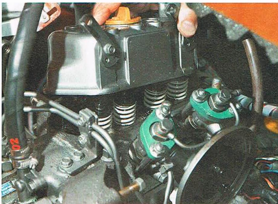
**GEÖFFNET** Nachdem alle Leitungen getrennt wurden, kann es ans Eingemachte gehen. Die Hälfte der Kopfbolzen steckt unter dem Ventildeckel, daher muss auch dieser weichen
