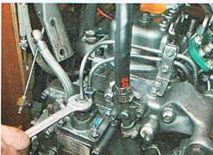
**GELÖST** Die Einspritzleitungen werden direkt an der Pumpe getrennt, damit sie samt Kopf abgenommen werden können
