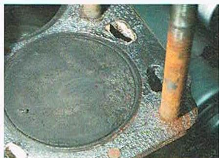
**GEFRESSEN** Die Feuchtigkeit hat deutliche Schäden hinterlassen. Die Oberfläche der Kolben ist durch Kavitation angefressen
