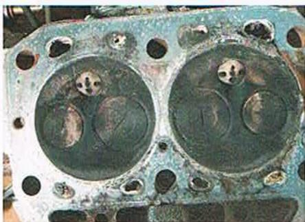
**GEBRANNT** Der Kopf von unten. Schwarze Spuren zwischen Brennraum und Kühlkanal deuten auf eine durchgebrannte Dichtung
