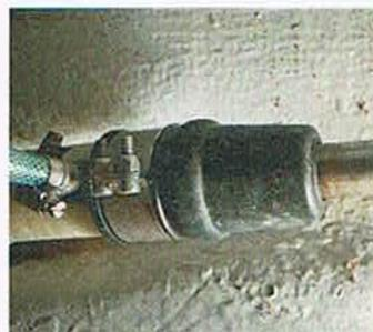
**Wellendichtung** Führt die sich drehende Welle durch den Rumpf und dichtet diese mit feinen Lippen gegen Außenwasser
