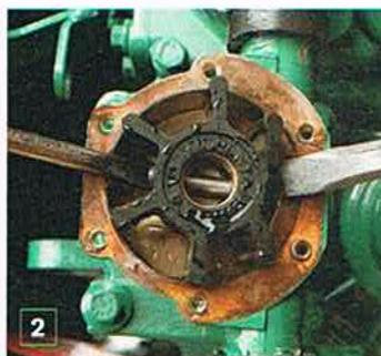
**Impeller entfernen** Am besten mit einem Abzieher, notfalls wie gezeigt mit zwei Schraubendrehern. Ein Tuch auf dem Gehäuse schützt vor Beschädigungen
