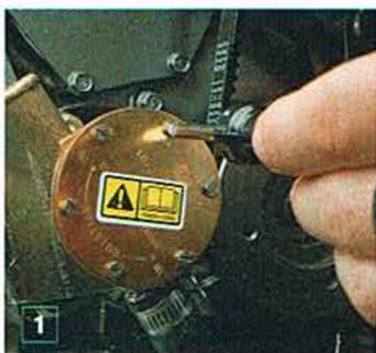
**Deckel öffnen** Zuvor: Seeventil schließen und ein Tuch für austretendes Wasser bereithalten. Schrauben sammeln. Deckel und Dichtflächen reinigen
