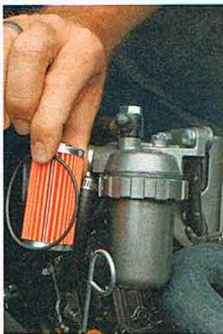
**Feinfilter** Sie verstopfen selten, wenn ein Vorfilter vorhanden ist. Zum Tauschen den Überwurf lösen. O-Ring immer gleich mitwechseln, fest andrehen. Entlüften: Obere Schraube öffnen und von Hand pumpen, bis keine Blasen mehr kommen
