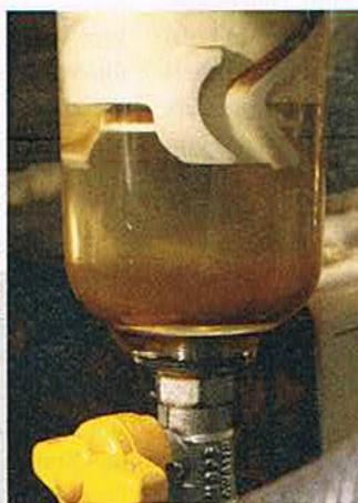
**Alternative I Separ** Zum Entwässern die gelbe Schraube um 90 Grad drehen. Der separierte Schmutz entweicht ebenfalls
