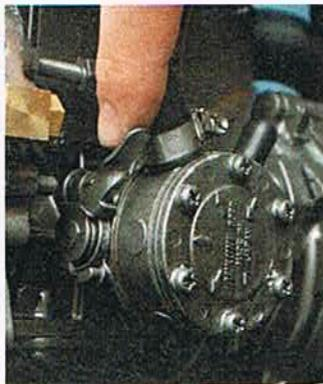
**Handpumpe Yanmar** Durch Betätigen des kleinen Hebels an der Kraftstoffpumpe wird Diesel in den Feinfilter und weiter in die Einspritzpumpe befördert
