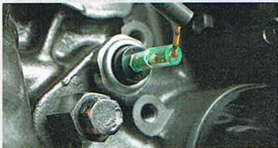
**Öldruckschalter** Er misst, ob genügend Schmierstoff vorhanden ist. Löst sich das Kabel vom Schalter, kann das bei einigen Motoren den Öldruckalarm auslösen
