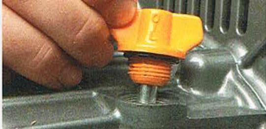
**Getriebeöl** Beim Prüfen den Stab bei Volvo nur auflegen, bei Yanmar ganz eindrehen. Weißliches Öl bedeutet bei Saildrives, dass Wasser eingedrungen ist
