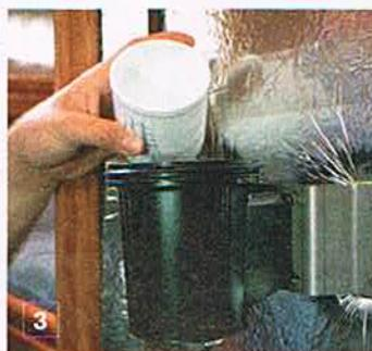
**Filterelement einsetzen** Auf korrekten Sitz achten, oft passt es nur in einer Stellung. Dann den Filter mit Wasser befüllen
