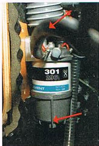
**Vorfilter mit Wasserabscheider** Folgt nach dem Absperrhahn des Tanks. Zum Entwässern die Schraube unten öffnen, bis Diesel entströmt. Zum Entlüften die obere öffnen, bis keine Luftblasen mehr austreten. Tuch bereithalten
