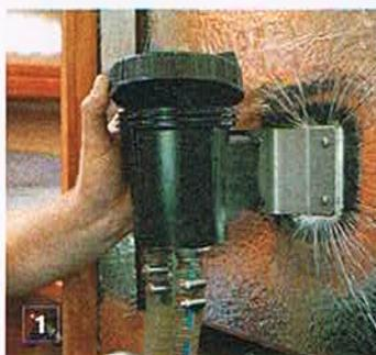
**Deckel auf** Zuvor: Seeventil schließen! Transparente Deckel ermöglichen die Kontrolle ohne Öffnen. Deckel sitzt oft sehr fest
