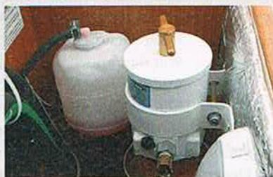
**Alternative II Parker** Die Messingschraube auf dem Deckel ist zur Entlüftung. Unter dem Filter ist ein Wärmeabweiser angebracht. Er dient beim Entwässern nicht zum Auffangen von austretenden Flüssigkeiten
