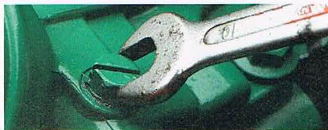
**Einspritzpumpe entlüften** Bei aktuellen Motoren entlüftet sich die Pumpe selbst, bei älteren hier die Prozedur wie an den Filtern wiederholen. Aufpassen: Kupferdichtung nicht zu fest anziehen
