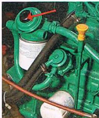
**Handpumpe Volvo** Sie sitzt gleich auf dem Feinfilter. Dahinter ist die Entlüftungsschraube. Zum Betätigen mit dem Handballen drücken
