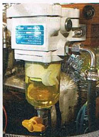
**Alternative I Separ** Das Filterelement sitzt unter dem Deckel oben. Darauf befindet sich die Entlüftungsschraube
